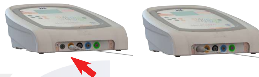
Imagem 16. Conexão do cabo de eletroestimulação para a corrente High Volt.
