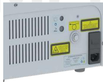
Após a troca dos fusíveis encaixe a gaveta dos fusíveis no equipamento.
