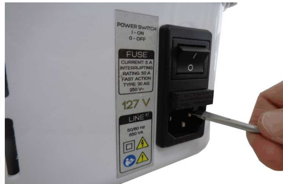
Imagem 16. Removendo a gaveta da caixa de fusível.
