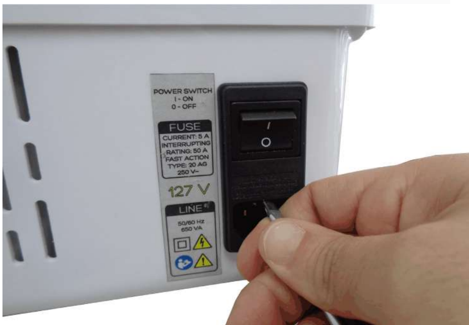
Imagem 15. Abrindo a caixa de fusível.
