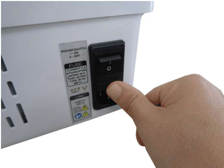
Imagem 17. Reposicionando a gaveta da caixa de fusível.
