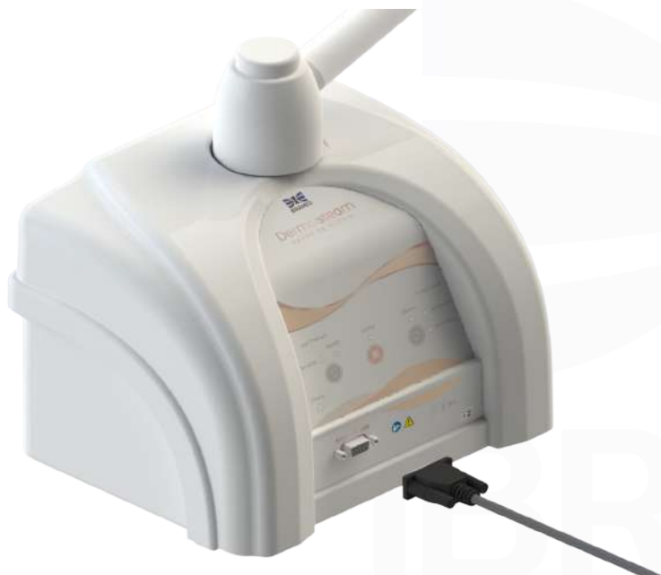
Imagem 13. Conexão da mini probe no canal de saída.
