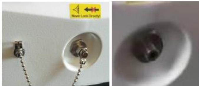
O chapéu protetor de abertura atua como proteção para a abertura do laser. Quando a fibra for removida, cubra a abertura do laser com um chapéu protetor de abertura imediatamente para evitar que a abertura seja contaminada.
