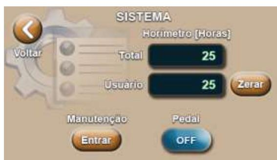
**Horímetro Total:** Mostra quantas horas a saída de Ultracavitação e PSW ficou em funcionamento.
