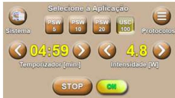
11. Para interromper a aplicação, pressione o pedal ou toque em STOP.
