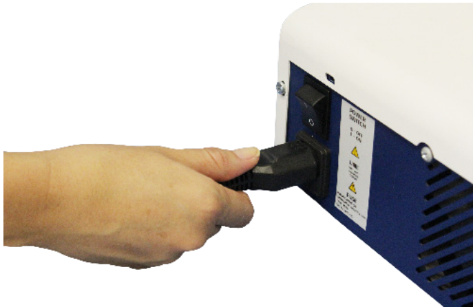
Figura 13. Conectando o cabo de alimentação elétrica.
