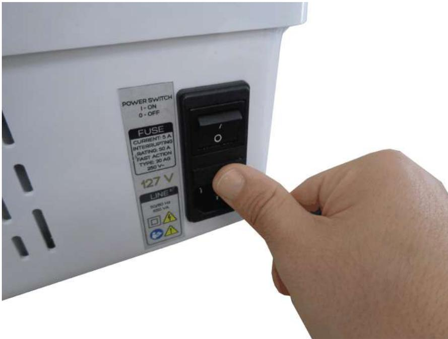
Imagem 17. Reposicionando a gaveta da caixa de fusível.
