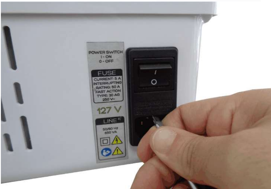
Imagem 15. Abrindo a caixa de fusível.
