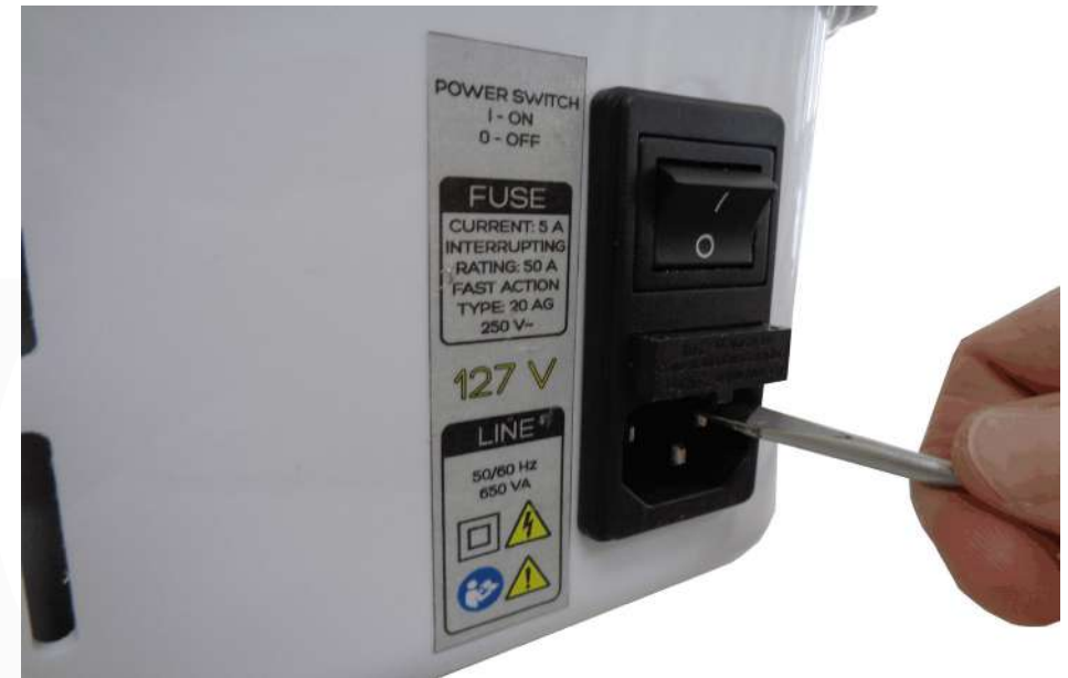
Imagem 16. Removendo a gaveta da caixa de fusível.
