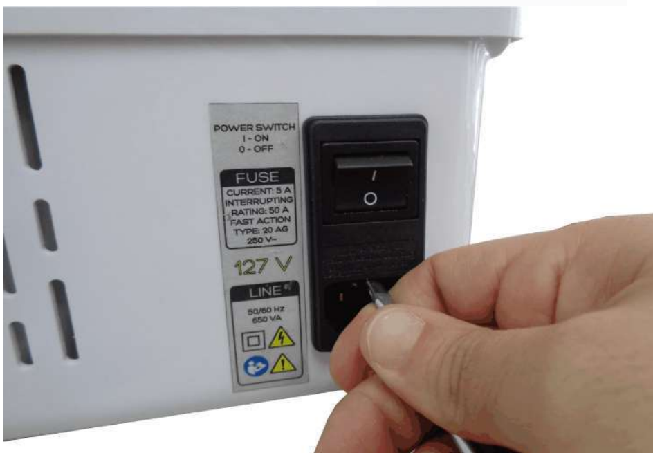
Imagem 15. Abrindo a caixa de fusível.
