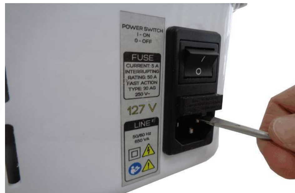
Imagem 16. Removendo a gaveta da caixa de fusível.
