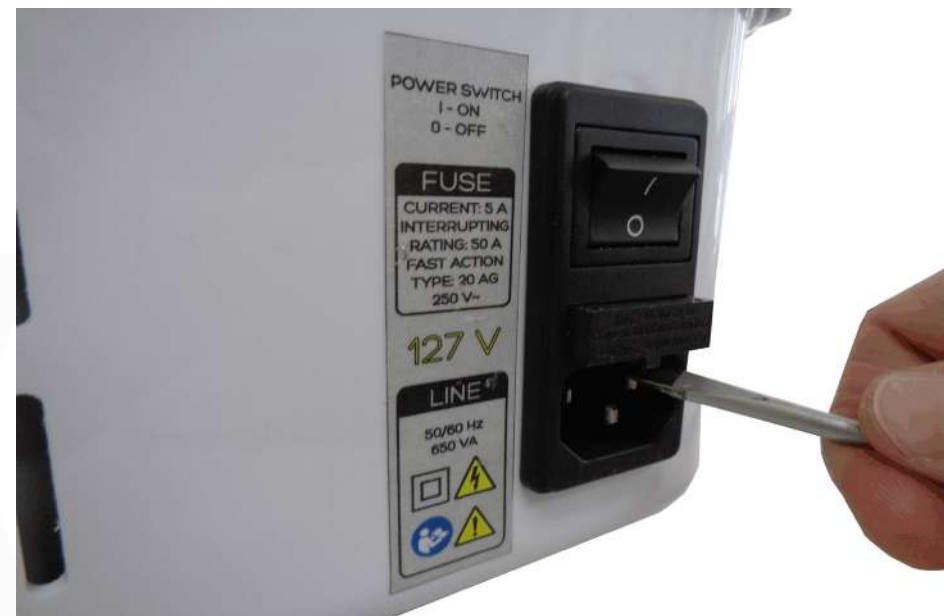
Imagem 16. Removendo a gaveta da caixa de fusível.
