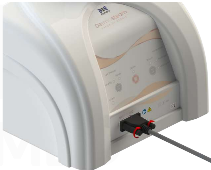
Imagem 14. Fixação da probe no canal de saída.
