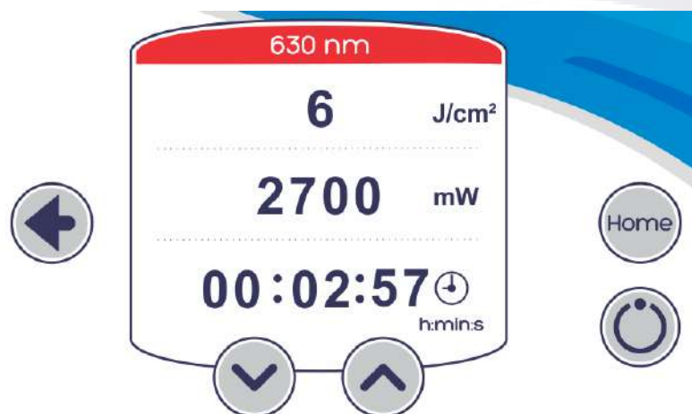
Figura 53. Exemplo de inserção de densidade de energia. Observe que o tempo de emissão é calculado automaticamente.
