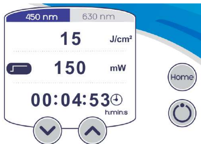
Figura 35. Parâmetros do comprimento de onda 450 nm para o preset Acne 2C .
