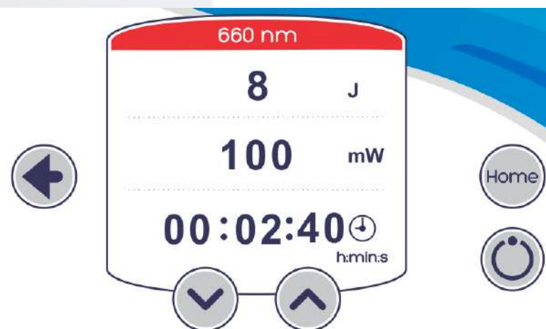
Figura 48. Exemplo de inserção de energia total. Observe que o tempo de emissão é calculado automaticamente.
