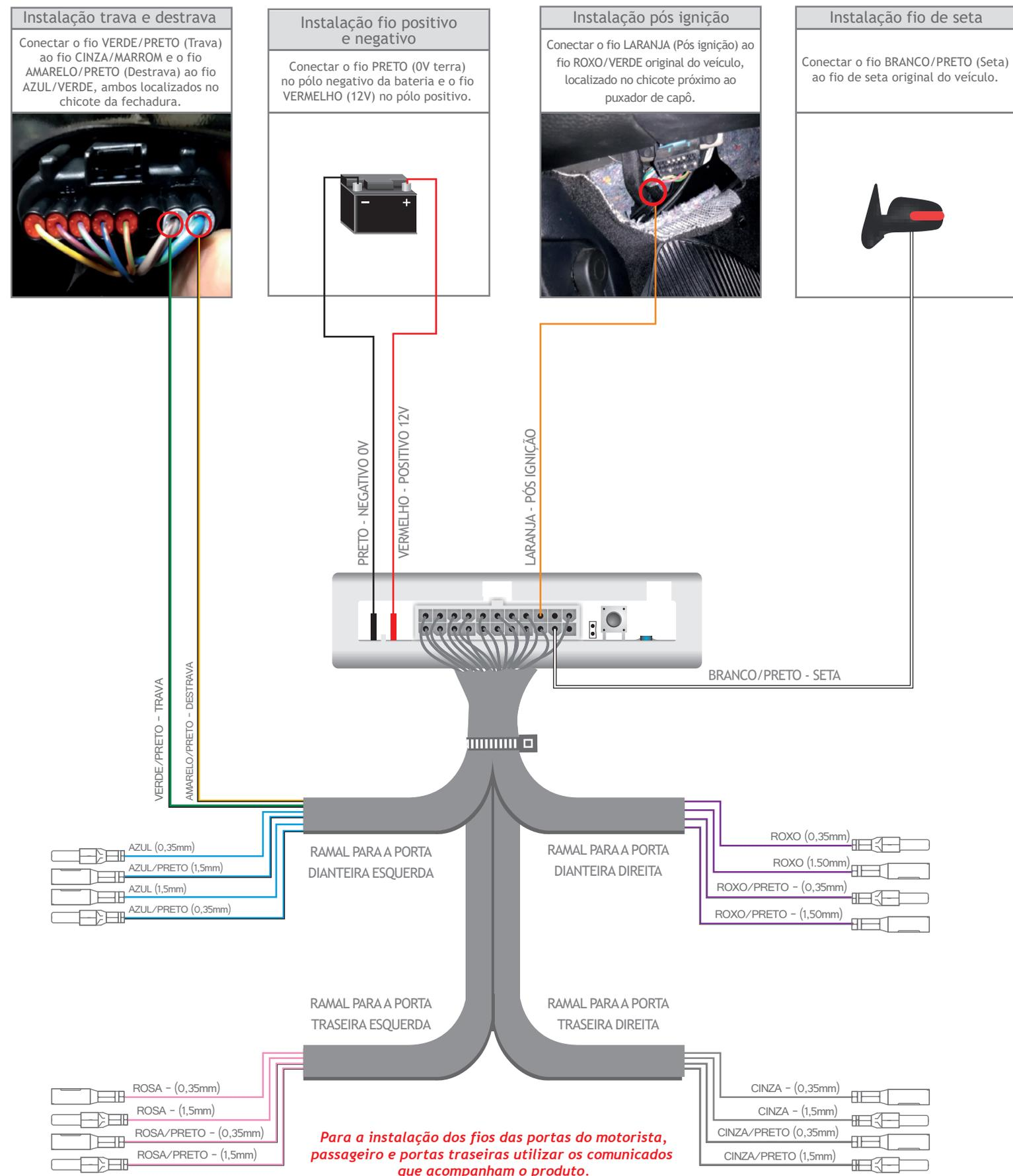
As cores dos fios originais e suas funções e localizações podem variar. Com um multímetro sempre verifique antes de instalar nossos produtos, para evitar possíveis problemas. A TURVY não se responsabiliza por danos causados no sistema elétrico do veículo por falhas de instalação.
