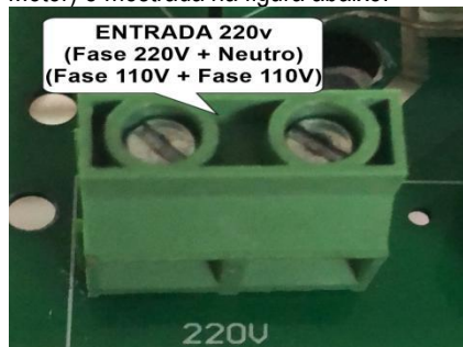
Entrada a dois fios 220V
