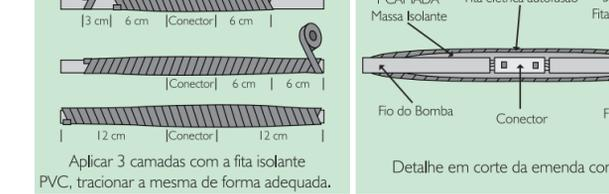
Aplicar 3 camadas com a fita isolante PVC, tracionar a mesma de forma adequada.
