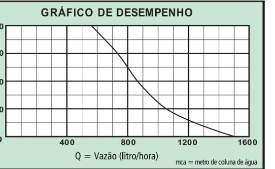
Obs.: As vazões da bomba estão sujeitas a variação devido ao nível de irradiação solar da região e condições meteorológicas.
