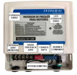
A disposição dos bornes para conexões elétricas, na parte de POTÊNCIA (Alimentação e saída para o Motor) é mostrada na figura abaixo.
