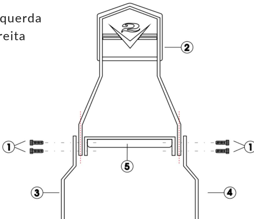
Encaixe na ordem mostrada acima: Laterais por fora, arco ao meio e bagageiro por dentro. São encaixados nos 4 furos com os parafusos 8x25 + arruela 8mm + porca travante 8mm.
