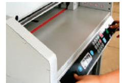
Assim que a prensa tocar as folhas tire o dedo do botão “CUT”, do contrário a máquina continuará o processo e em seguida descenderá a faca que cortará as folhas. Se você quer levantar a prensa, você deve pressionar o botão “CUT” do lado esquerdo do painel e apertar o botão “RESET”, assim a prensa voltará automaticamente para sua posição inicial. Pressione os botões “CUT” utilizando ambas as mãos e mantenha os botões pressionados para cortar seu material.
