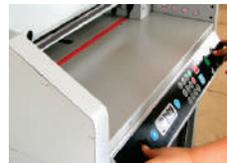
Assim que a prensa tocar as folhas tire o dedo do botão “CUT”, do contrário a máquina continuará o processo e em seguida descenderá a faca que cortará as folhas. Se você quer levantar a prensa, você deve pressionar o botão “CUT” do lado esquerdo do painel e apertar o botão “RESET”, assim a prensa voltará automaticamente para sua posição inicial. Pressione os botões “CUT” utilizando ambas as mãos e mantenha os botões pressionados para cortar seu material.
