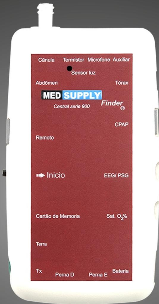
O módulo remoto tem como finalidade a confecção de protocolos de estudo e seu armazenamento. Também cumpre a função de inserir dados cadastrais dos pacientes e medir impedância dos eletrodos. Ele atende várias máquinas, não sendo necessário para o paciente.
