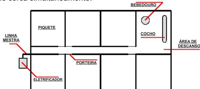
Para proteger contra descarga elétrica, instalar o Kit Para Raio Zebu na saída da cerca e o centelhador a cada 500m de cerca, ou desconectar o eletrificador da cerca nos dias em que ocorrem raios.
