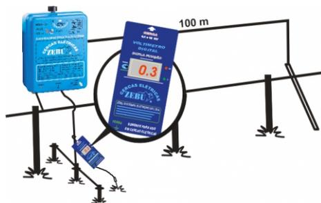
Ligue o eletrificador e em seguida utilize um voltímetro digital, crave a haste de metal do voltímetro no solo e pendure o voltímetro pelo gancho no cabo do terra. Caso a leitura do voltímetro for superior a 0,3kV, torna-se necessário instalar mais uma haste, enterrando-a a três metros de distância da primeira. O teste deve ser repetido até que a tensão medida não seja superior a 0,3kV.
