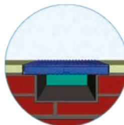
Calha de vazão
