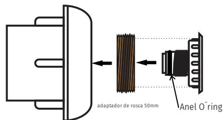
Encaixe em Dispositivo de Aspiração
