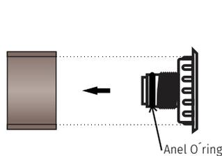
Encaixe em tubo de 50mm
