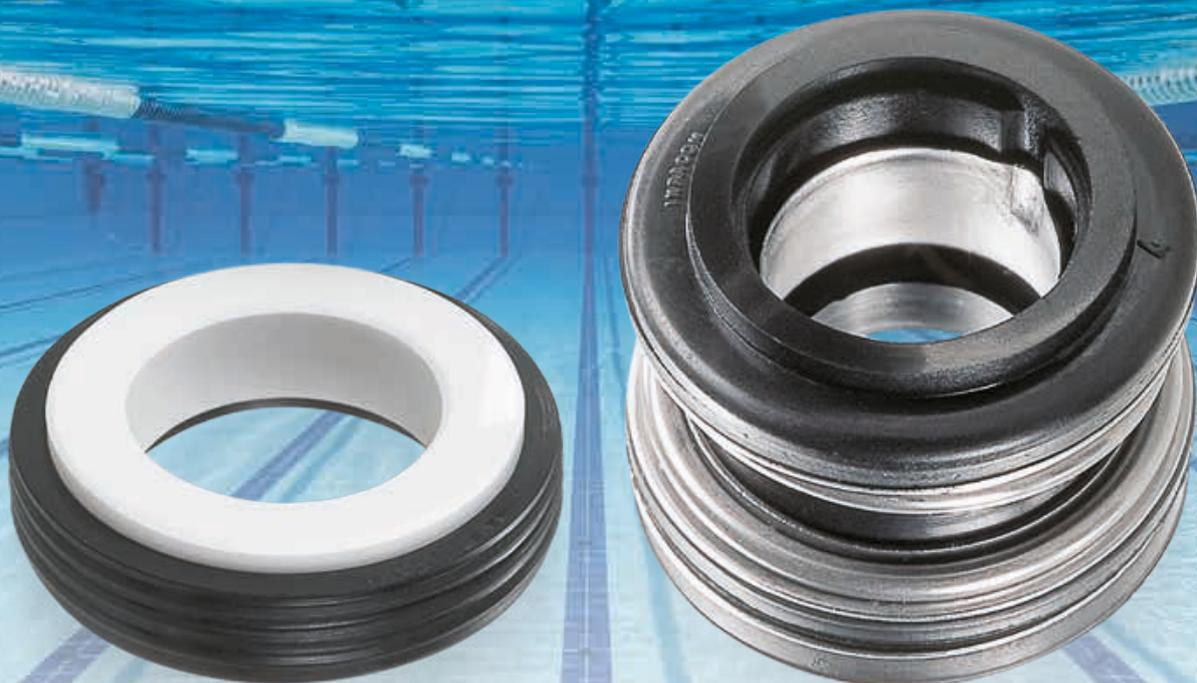
Selo com fole de elastômero cuja a característica é de proteger o eixo da bomba contra corrosão, é de fácil instalação visto que não possui componentes soltos. Para aplicações mais agressivas quimicamente, deve ser observado o fole em elastômero, pois está em contato direto com o fluido bombeado.
