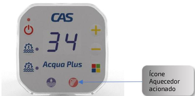
Após o aquecedor estar ligado por mais de 30 segundos (**ícone aquecedor aceso**), ao desligar a motobomba 01 (ver item 6.2), o aquecedor será desligado (**ícone aquecedor apagado**) e uma contagem regressiva de 12 segundos aparecerá no display do painel indicando o resfriamento do aquecedor.
