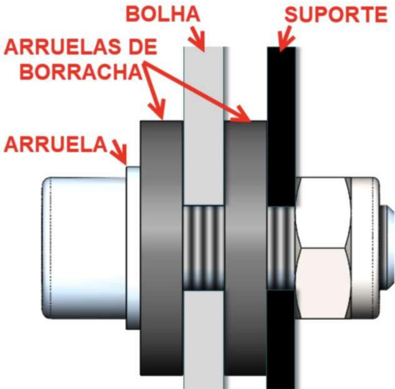
**Não aplicar torque excessivo.
