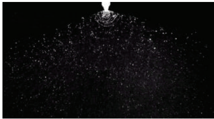
Padrão de spray de gota grande e amplitude de 140°, visando a melhor cobertura da indústria para fertilizantes líquidos.
