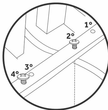
**DICA:** Os furos que corretos para colocar os parafusos na estrutura dos pés, são o 2° e o 4°, contando do "corte" até a "curva" da "haste". São os mais ao centro do "haste".
