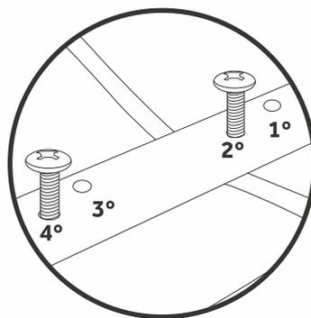
**DICA:** Os furos que corretos para colocar os parafusos na estrutura dos pés, são o 2º e o 4º, contando do "corte" até a "curva" da "haste". São os mais ao centro da "haste".
