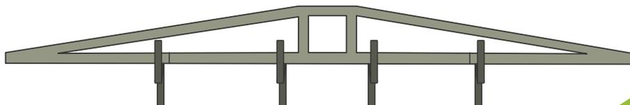
É imprescindível que o sistema de lâmpadas seja instalado abaixo da linha dos bicos, direcionando o foco de luz na cortina d'água.
