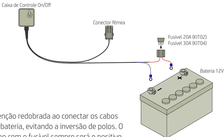
Atenção redobrada ao conectar os cabos da bateria, evitando a inversão de polos. O cabo com o fusível sempre será o positivo.
