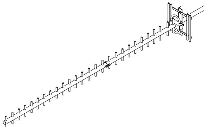
IV – Montagem da antena na torre com o KIT080. Usar chave de boca de 9/16" e 1/2".
