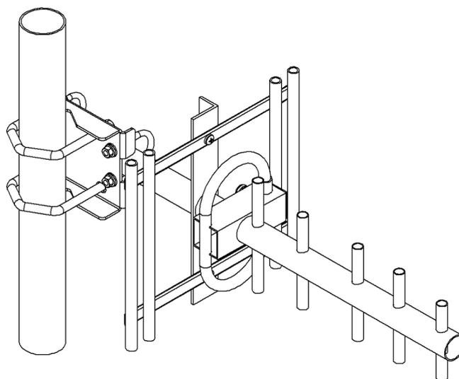
IV – Montagem da antena na torre com o KIT095. Usar chave de boca de 9/16" e 7/16".
