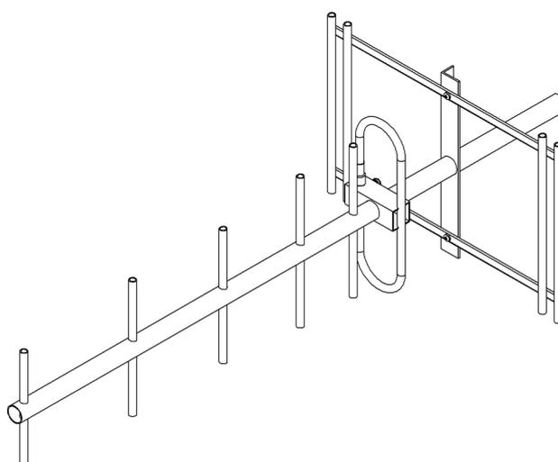
IV – Montagem da antena na torre com o KIT080. Usar chave de boca de 9/16" e 1/2".
