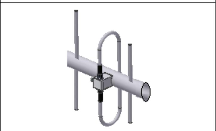
III – Faça uma pingadeira e isole a conexão
