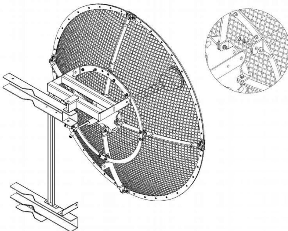
IV – Fixação do esticador superior ligando a Antena para a Estrutura. Usar chave de boca 7/16”.
