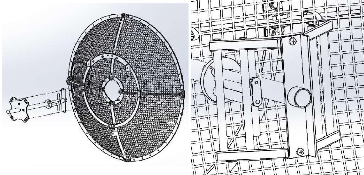
III – Fixação da Antena na parte superior da Estrutura. Usar chave de boca 7/16” para os parafusos.
