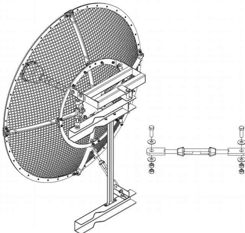
O esticador superior propõem o ajuste de azimute.
