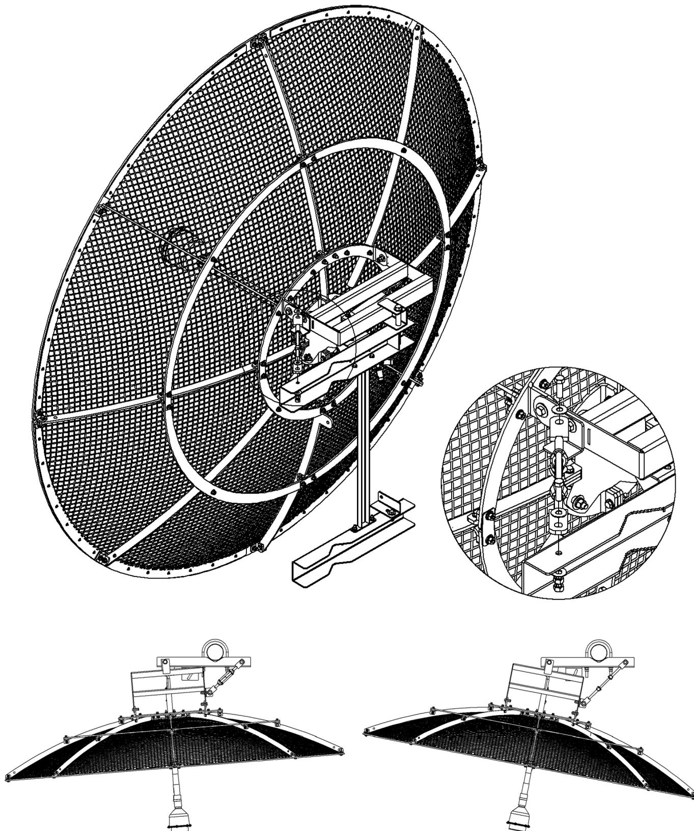
O esticador superior propõem o ajuste de azimute.
