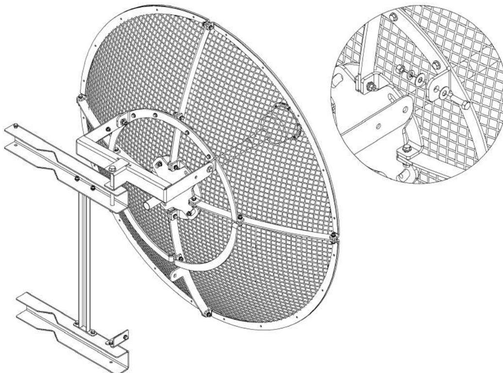
IV – Fixação do esticador superior ligando a Antena para a Estrutura. Usar chave de boca 7/16”.
