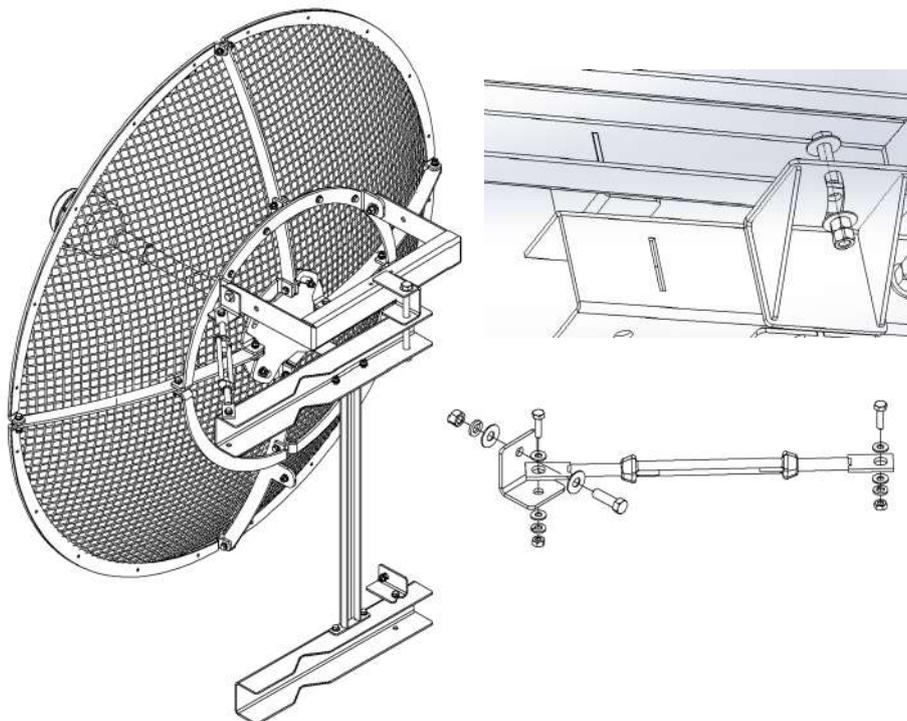
O esticador superior propõem o ajuste de azimute. Após ajustar o azimute fixar o parafuso localizado no interior do suporte conforme imagem.
