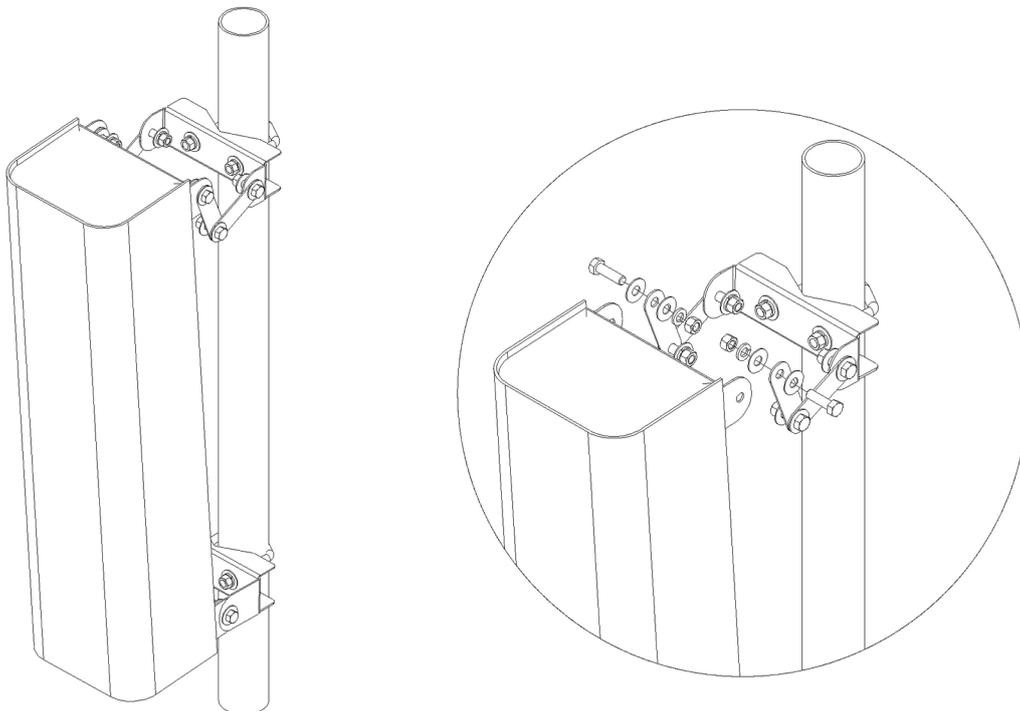
II – Montagem do painel ao suporte de fixação. Utilizar ferramenta, chave de boca 9/16", para o KIT118.
