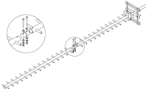
II – Montagem da grade refletora na antena, usar o KIT143 para a fixação. Usar chave de boca 10 mm.
