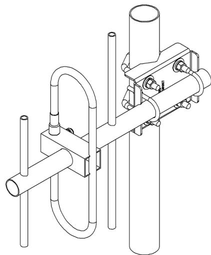
IV – Montagem da antena na torre com o KIT095. Usar chave de boca de 9/16" e 7/16".
