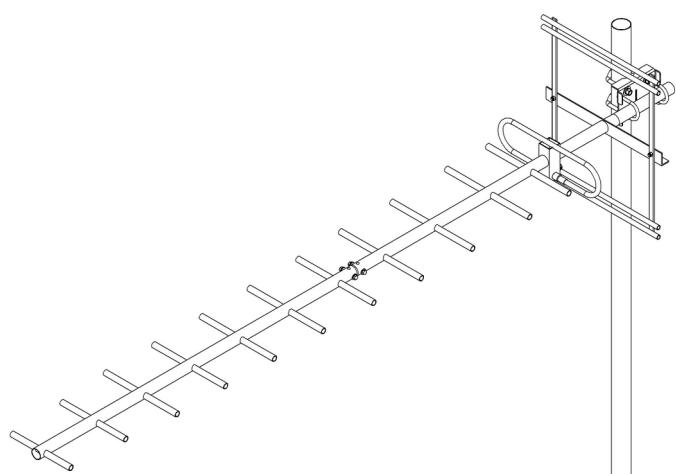
V – Montagem da antena na torre com o KIT080. Usar chave de boca de 9/16" e 1/2".
