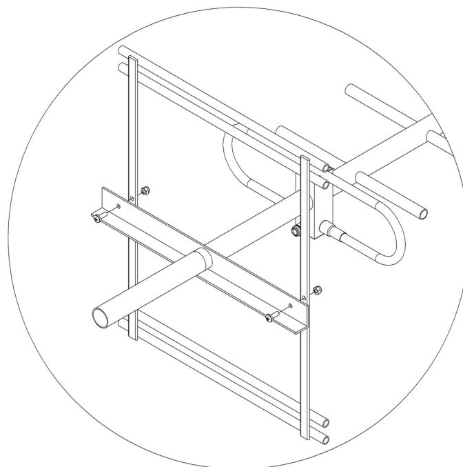
II – Montagem da antena na torre com o KIT080. Usar chave de boca de 9/16" e 1/2".
