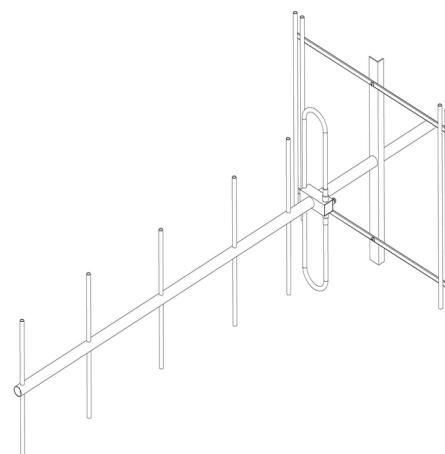
IV – Montagem da antena na torre com o KIT080. Usar chave de boca de 9/16" e 1/2".
