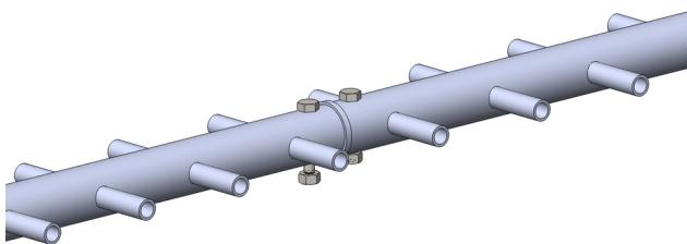
II – Montagem da grade refletora na antena, usar o KIT143 para a fixação. Usar chave de boca 10 mm.
