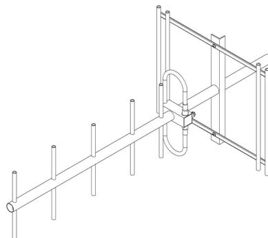
IV – Montagem da antena na torre com o KIT080. Usar chave de boca de 9/16" e 1/2".
