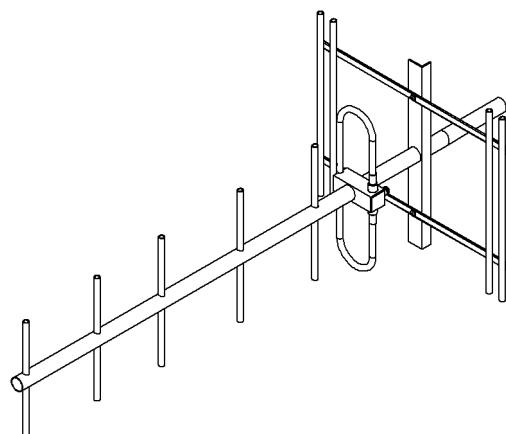
IV – Montagem da antena na torre com o KIT080. Usar chave de boca de 9/16" e 1/2".
