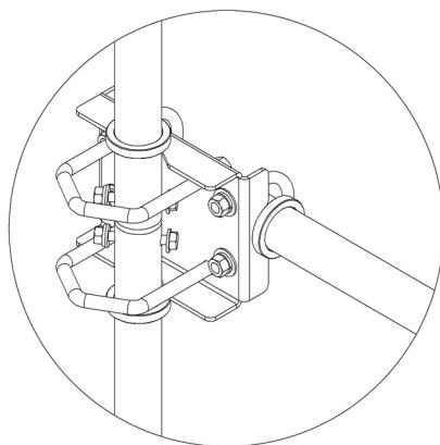
IV – Posicione ambos os conjuntos certificando-se que os suportes de sustentação dos dipolos estão todos orientados da mesma maneira. Como o arranjo de dipolos é um conjunto “co-fasado” a inversão dos posicionamento pode acarretar em um nulo de diagrama de irradiação na linha do horizonte.
