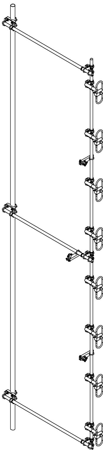
II – Fixação das suporte galvanizadas no mastro.
