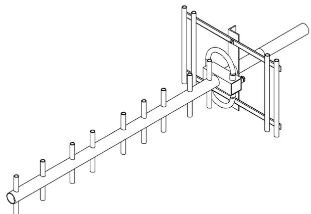
IV – Montagem da antena na torre com o KIT080. Usar chave de boca de 9/16" e 1/2".
