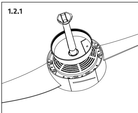
1.3 Com a chave Phillips, fixe as pás ao motor com os 6 parafusos. Dois em cada peça, nos furos disponíveis.
