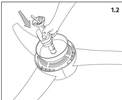
1.2.1 Insira o conjunto de pás + junções previamente montadas no conjunto do motor (composto pelo motor, haste, canopla e capa) alinhando os furos das pás com os furos do motor que não contenham parafusos previamente inseridos.
