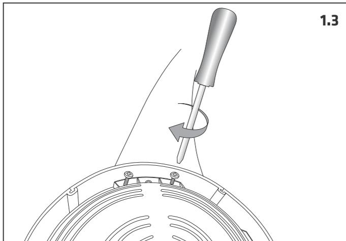
**IMPORTANTE:** Passe a mão pelo topo do conjunto circular para conferir se os encaixes estão corretamente nivelados. Caso exista alguma saliência nas junções das pás, ajuste-as novamente de modo que fiquem niveladas.
