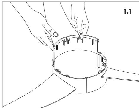
1.1.1 Utilizando as 2 pás, monte o conjunto circular do Lunik2®, encaixando a pá em sequência a junção. Utilize o dedo polegar como apoio na parte superior da pá e o dedo indicador para guiar a peça no friso por onde deve correr a pá.
