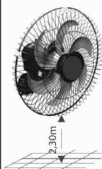
**ATENÇÃO:** Os Ventiladores BIVOLT saem da fábrica ligados em 220 V.
