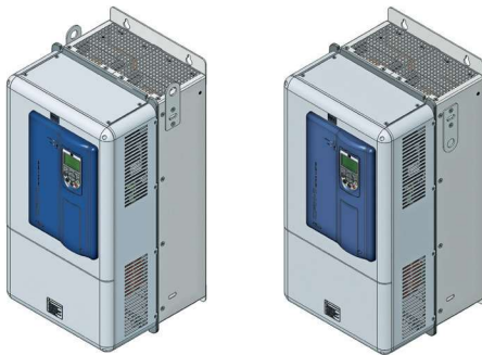
Figura 4: Instalação das chapas para içamento do inversor das mecânicas E, F, G e H
