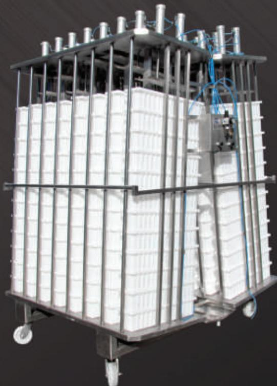
As Prensas Pneumáticas são construídas totalmente em aço inox 304, com calha para coleta de soro na parte inferior.
