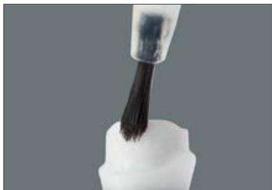
Aplicação de um promotor de aderência contendo monômero de fosfato como, p. ex, CLEARFIL CERAMIC PRIMER (Fa. Kuraray) com um pincel descartável ou microescova.
