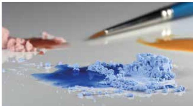
Para uma melhor molhabilidade dos pigmentos e materiais para glaze, a superfície pode ser molhada com um pouco de IPS Ivocolor Mixing Liquid.
