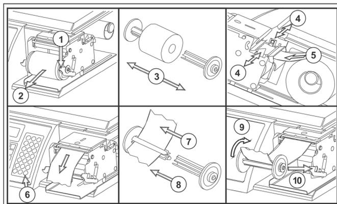
1. Abaixar a alavanca de trava do rebobinador e puxe a impressora para frente até que ela saia do interior do gabinete da Prix 6. A impressora desliza sobre um guia no chassi da balança, permitindo movimentação para dentro e fora do gabinete da balança. Durante o uso a impressora deverá estar posicionada dentro da Prix 6. A mobilidade da impressora é travada pelo encaixe da trava esquerda do liner no orifício existente no chassi da Prix 6 (lado esquerdo da impressora).
