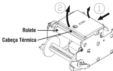
Passe a caneta transversalmente sobre a superfície da cabeça térmica.
