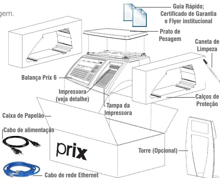
Após retirar a Prix 6 da caixa de papelão, remova a tampa da impressora e retire o calço de papelão do mecanismo da impressora.
